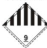
Matières et objets dangereux divers, y compris les matières dangereuses pour l'environnement
